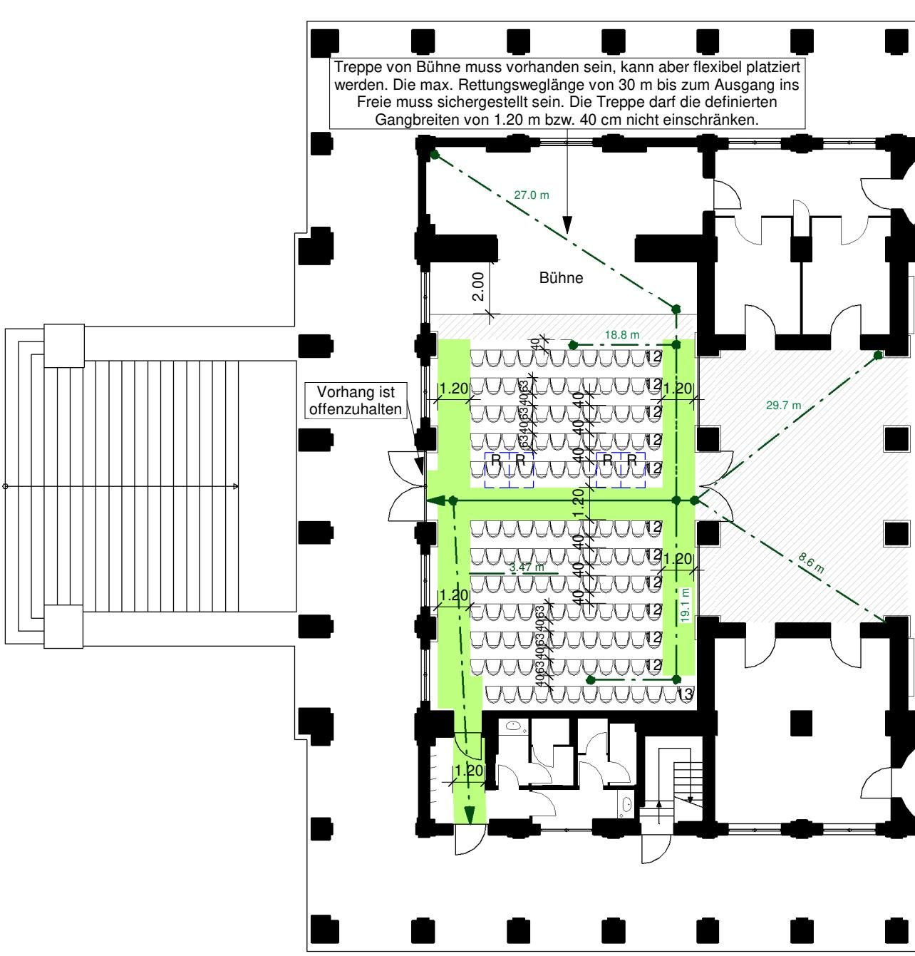
Treppe von Bühne muss vorhanden sein, kann aber flexibel platziert werden. Die max. Rettungsweglänge von 30 m bis zum Ausgang ins Freie muss sichergestellt sein. Die Treppe darf die definierten Gangbreiten von 1,20 m bzw. 40 cm nicht einschränken.
